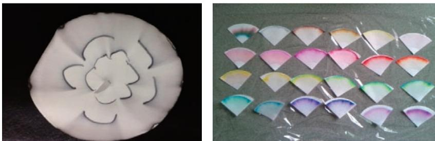
図2：左-ろ紙を用いたクロマトグラフィ 右-1/4にしたろ紙でのクロマトグラフィ
